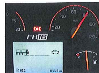
Rote LEDs leuchten auf, wenn das ACC-System nicht die Kapazität besitzt, die Geschwindigkeit ausreichend zu reduzieren. Darüber hinaus ertönt im Falle einer Kollisionswarnung ein akustisches Signal.
