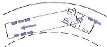
ESP bremst das äußere Vorderrad, um den Sattelzug auf Kurs zu bringen und den Hinterrädern Grip zu verleihen. Der Auflieger wird gebremst, ein Einknicken verhindert.
