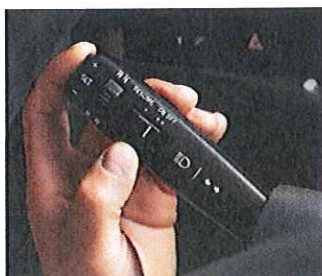
Die ACC-Steuerung. Der zeitliche Abstand kann mit dem Regler am Hebel leicht vergrößert oder verringert werden.
