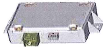
Das Videoverarbeitungsgerät wird in die Radiokonsole eingebaut.
