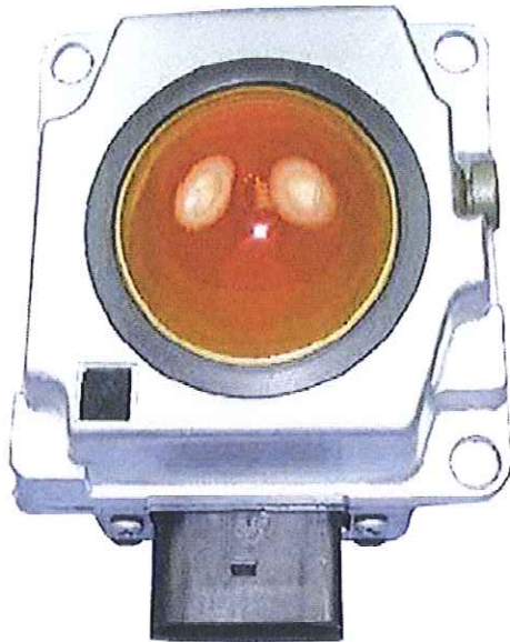
Das ACC-System basiert auf einem fortschrittlichen Doppler-Radar, das die Frequenz des ausgesendeten Impulses mit der des empfangenen Echos vergleicht.
