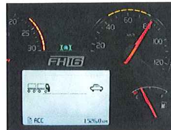
Ein grüne LED zeigt die bei der Geschwindigkeitsregelung eingestellte Geschwindigkeit an. Die untere gelbe LED zeigt die Geschwindigkeit des vom ACC-System erfassten Zielfahrzeugs an. Die zusätzlichen gelben LEDs zwischen der unteren gelben LED und der grünen LED für die aktuell eingeregelt Geschwindigkeit dienen zur Anzeige der relativen Geschwindigkeitsdifferenz zwischen Lkw und Zielfahrzeug.
